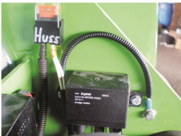
Endergebnis: eingebaute Sicherung
