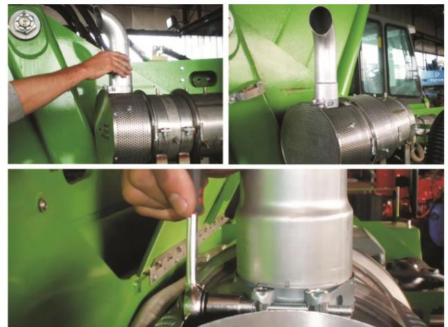
*Positionierung und Befestigung des Abgasaustrittsrohrs*
