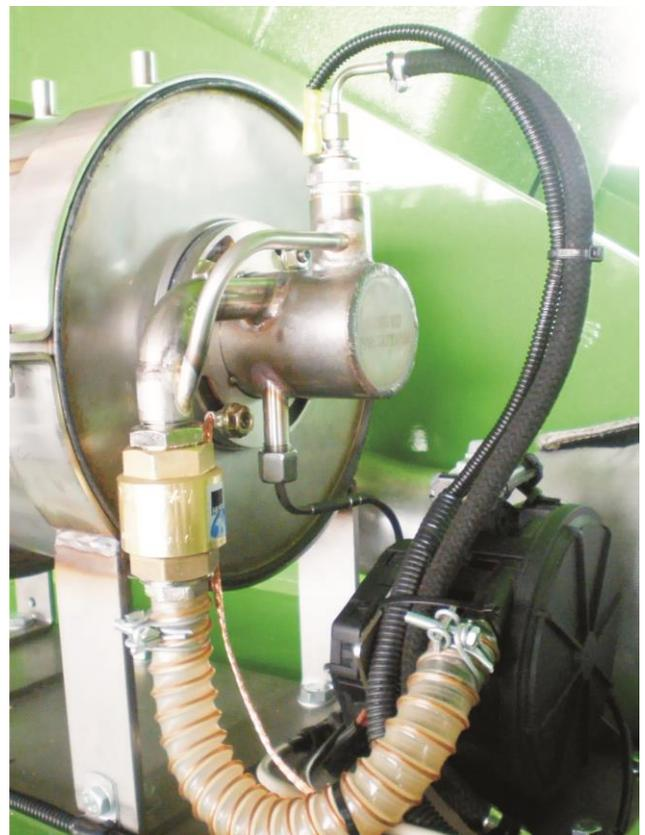
Ergebnis: fertig montierter Brenner
