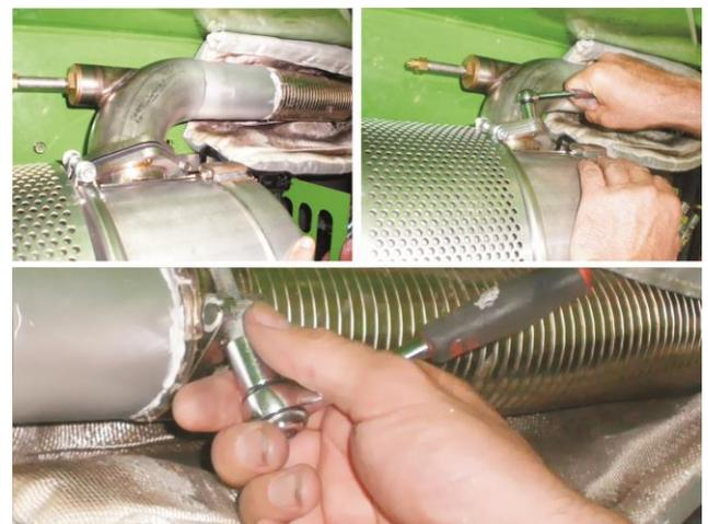
*Anschluss eines Abgaseintrittsrohrs*
