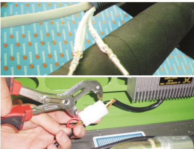
Anschluss eines Spannungswandlers
