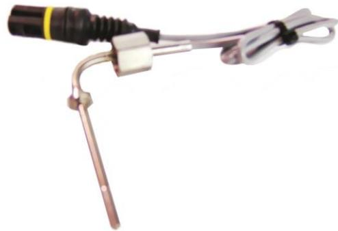
Der Temperatursensor ist mit seiner Überwurfmutter an den entsprechenden Stutzen des Brenners zu schrauben und festzuziehen. Dabei ist darauf zu achten, dass man den Sensor nicht zu fest anzieht, damit er den Boden der Tauchhülse nicht berührt und nicht knickt. Sollten am Temperatursensor zusätzliche Unterlegscheiben mitgeliefert werden, so sind diese als zusätzliche Distanz zu montieren. Das maximal zulässiger Anziehdrehmoment des Temperatursensors beträgt 7Nm.
