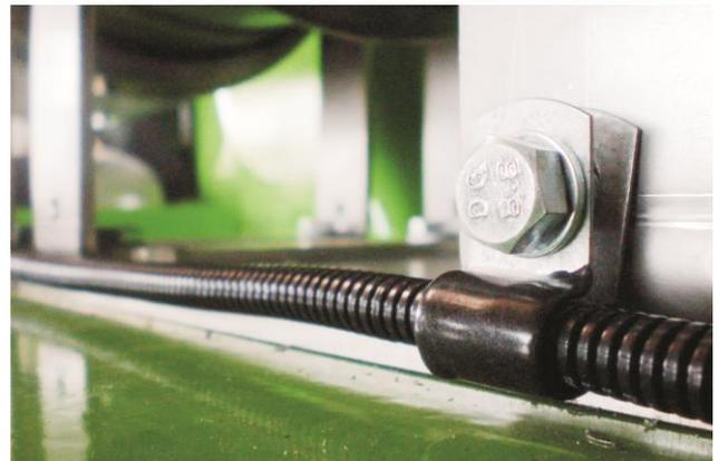
*Dichte Verbindung bei Verlängerung*
