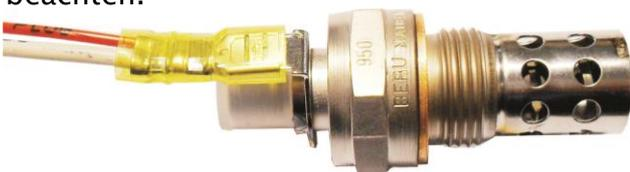
**Abbildung 3:** Stecken Sie den gelben Flachsteckkontakt auf die Glühkerze.
