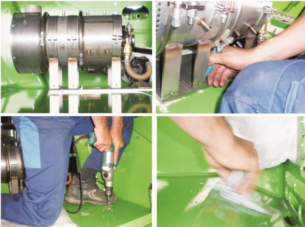
*Anpassen, Markieren, Bohren und Reinigen*
