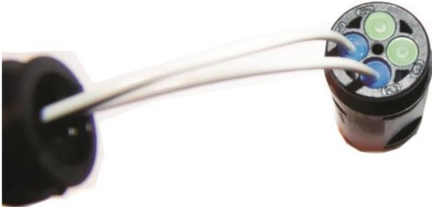
**Abbildung 3:** Stecken Sie die beiden Kabel auf die Steckplätze 1 und 2 des Steckers bis sie hörbar einrasten und sich nicht mehr herausziehen lassen. Stecken Sie die grünen Gummidichtpfropfen in die beiden verbleibenden Steckplätze 3 und 4 um diese abzudichten.
