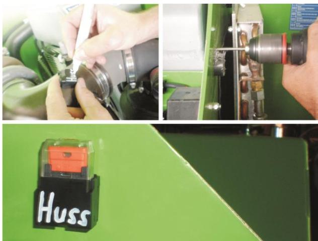
Installation und Markierung einer Sicherung
