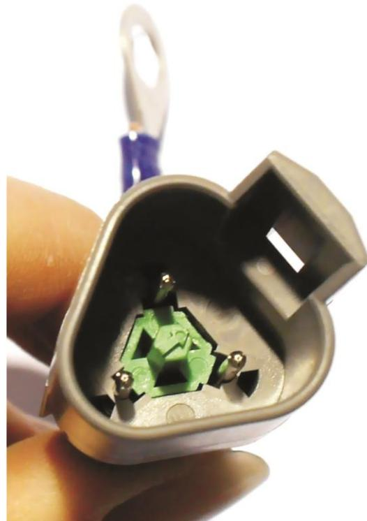
**Abbildung 4:** Die Kontakte sind so in den Stecker zu stecken, dass dieser richtig belegt wird (Masse = braun, 24V Eingang = rot, 12V Ausgang = grün). Die grüne Sicherung ist so in den Stecker zu stecken, dass der Pfeil in die gleiche Richtung zeigt, wie der Pfeil im Gegenstecker.
