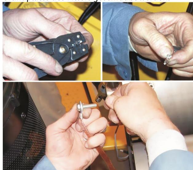
Für den sicheren Masseanschluss müssen Zahn- und Federscheiben eingesetzt werden.
