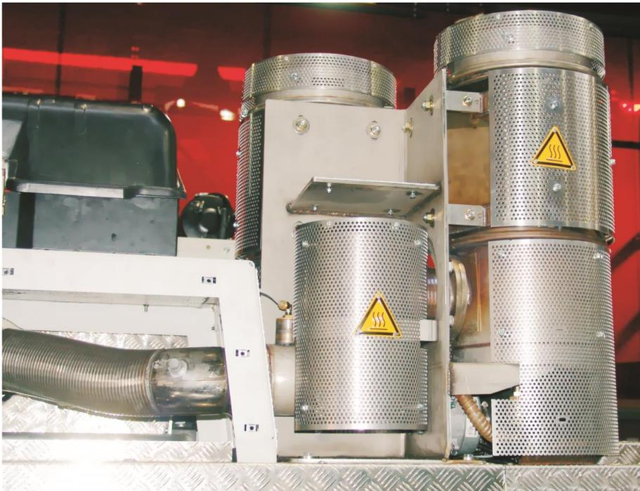
Abgasverteiler (Y- oder Doppel Y- , 3 Wege- bzw. Sternverteiler) zu verwenden (siehe nachfolgende Bilder). Zwischen Abgasverteiler und Filtereintritt muss zur Entkoppelung ein Stück der Strecke mit Flexrohr ausgeführt werden (min.Länge = 3x Abgasrohrdurchmesser).
