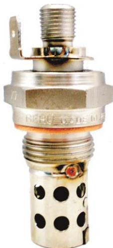
Beim senkrechten Einbau muss der Filter eine leichte Neigung haben  $8^\circ (+/-3^\circ)$ , damit die Glühkerze nicht mit Diesel überfüllt werden kann. Beim waagrechten Einbau muss die Glühkerze senkrecht ( $90^\circ +/- 5^\circ$ ) positioniert werden. Das maximal zulässiger Anziehdrehmoment des Kraftstoffanschlusses beträgt 7Nm.
