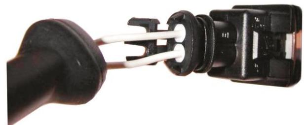
**Abbildung 4:** Stecker Kraftstoffpumpe mit eingesteckten Kontakten
