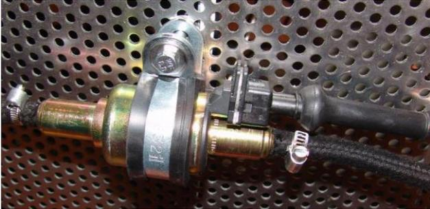
**Abbildung 5:** montierte Kraftstoffpumpe inkl. aufgestecktem Stecker
